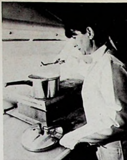
Voor vochtbestendigheidsprouwen worden de standaardtypen gelijkrichters van SCI gedurende vier uur verhit in een hogedrukpan.
